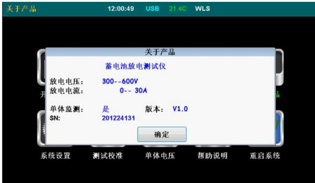
在主页面中点击“关于产品”图标，会弹出关于产品对话框，该对话框中显示出本产的相关规格参数。
