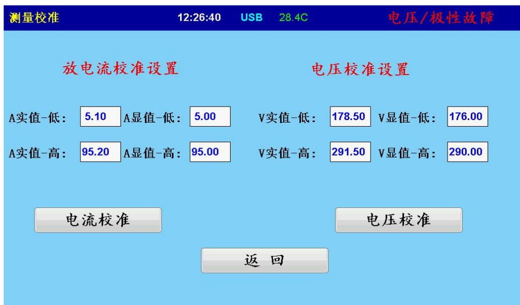
在测试校准页面中，可以分别对充电电流、放电电流、电压三个值进行校准。在对这三个进行校准前，必须事先记录好4个参数：A实值低、A实值高；V实值低、V实值高。
