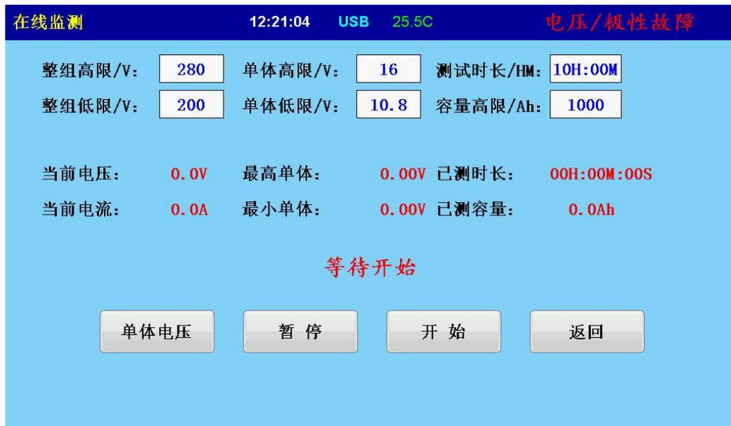
很多情况下，需要验证一组蓄电池的真实带负载的带载能力，即只需要监测其单体电压和总电压、总电流值，但又不需要对蓄电池组进行实际的放电测试，这里就可以用到在线监测功能。
