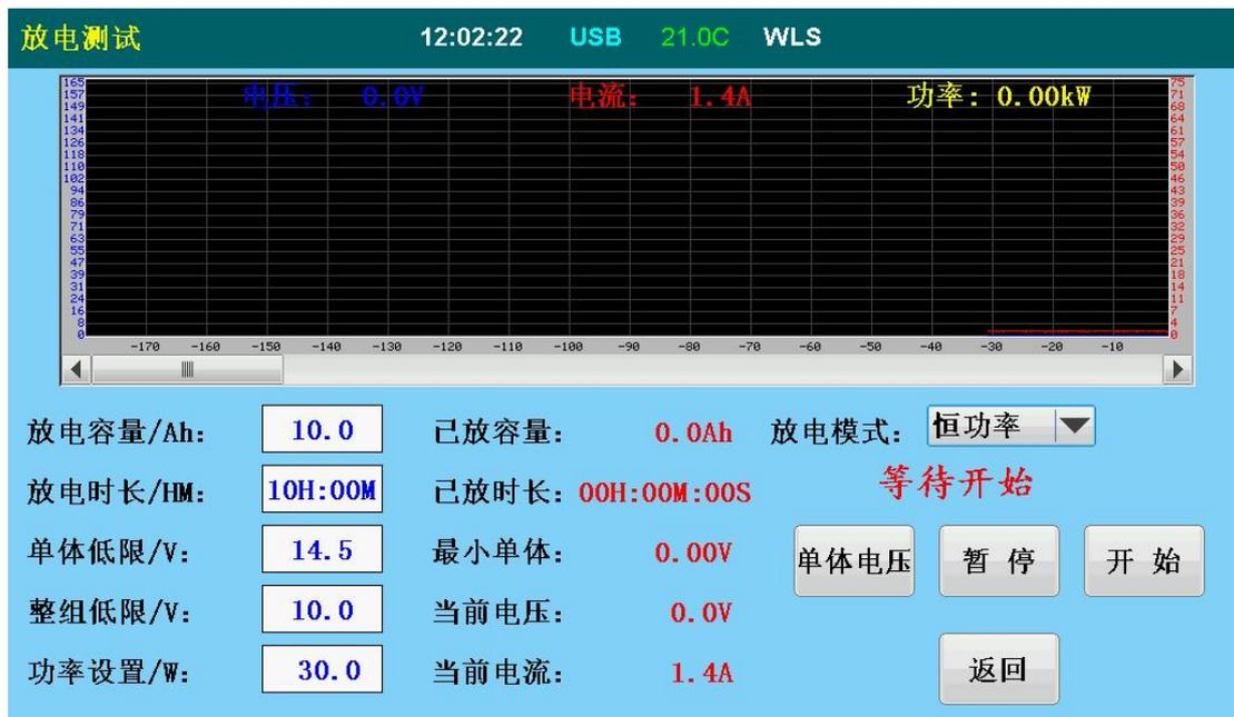
注意：当更改放电模式为“恒功率”时，则放电参数设置显示为“放电功率/W”。
