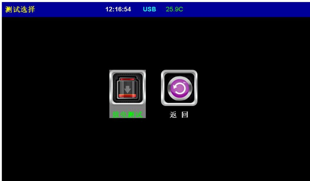
根据您需要进行的测试，点击相应的图标后，进入到对应的测试界面。在进入相应的测试界面之前，系统会自动引导您进行模版参数的选择，根据之前已经预设好的6个模版参数进行选择，如下图：
