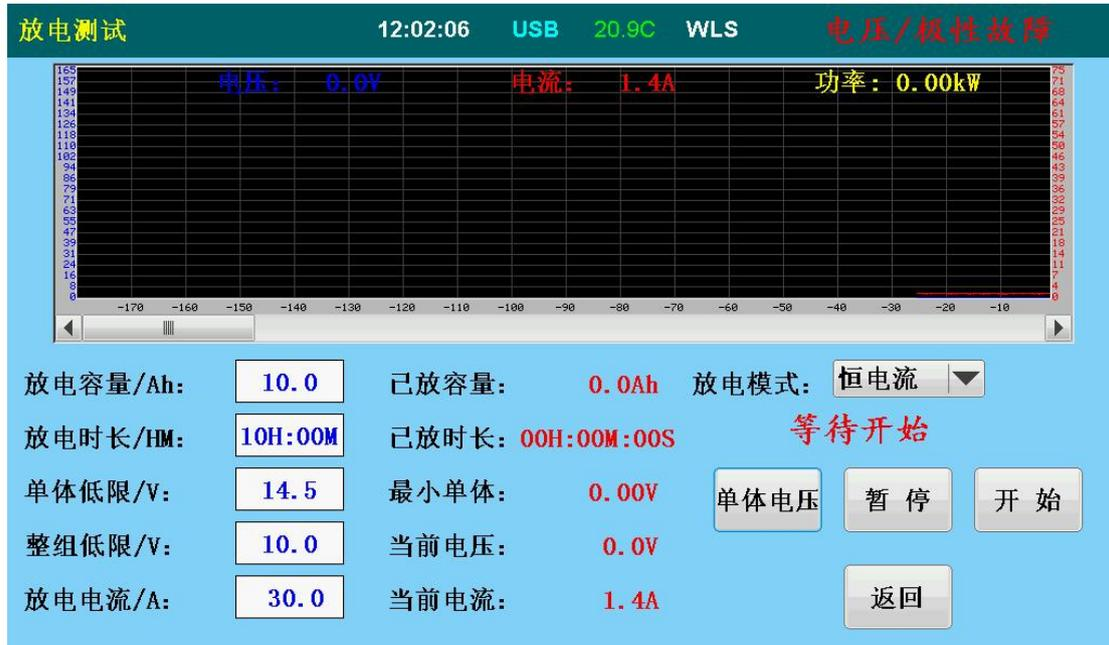
注意：当更改放电模式为“恒电流”时，则放电参数设置显示为“放电电流/A”。
