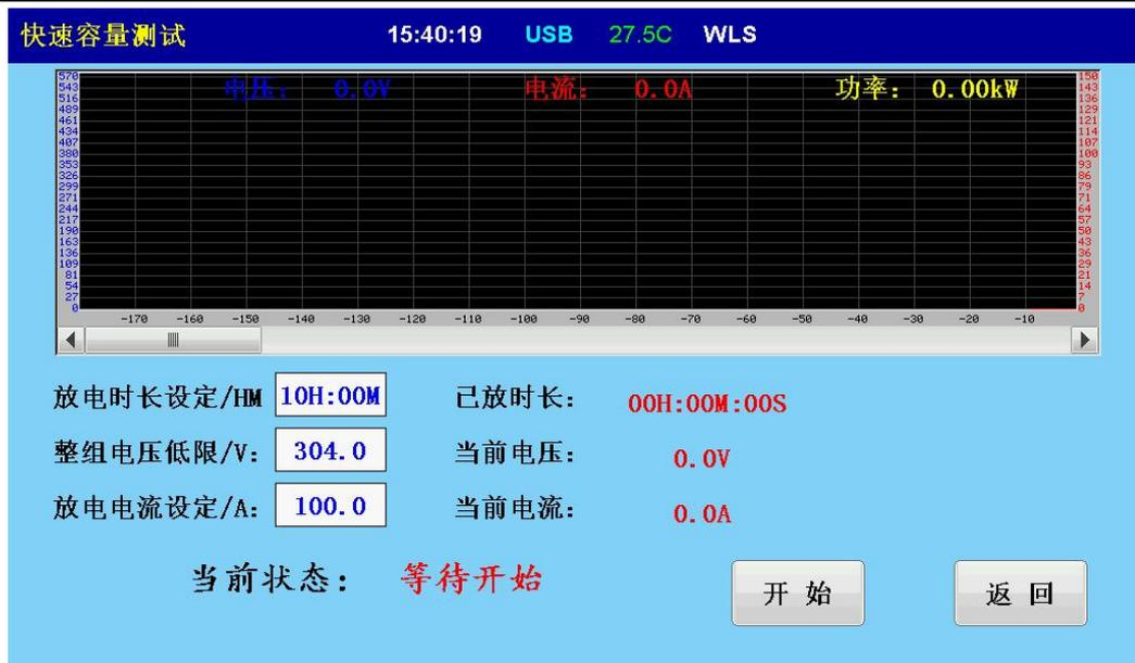
很多情况下，使用者不想设置太多的参数而进行放电测试，这时可以进入到快速测试界面，只需要设置【放电时长】、【整组电压低限】、【放电电流】简单的三个参数即可，简单又方便！
