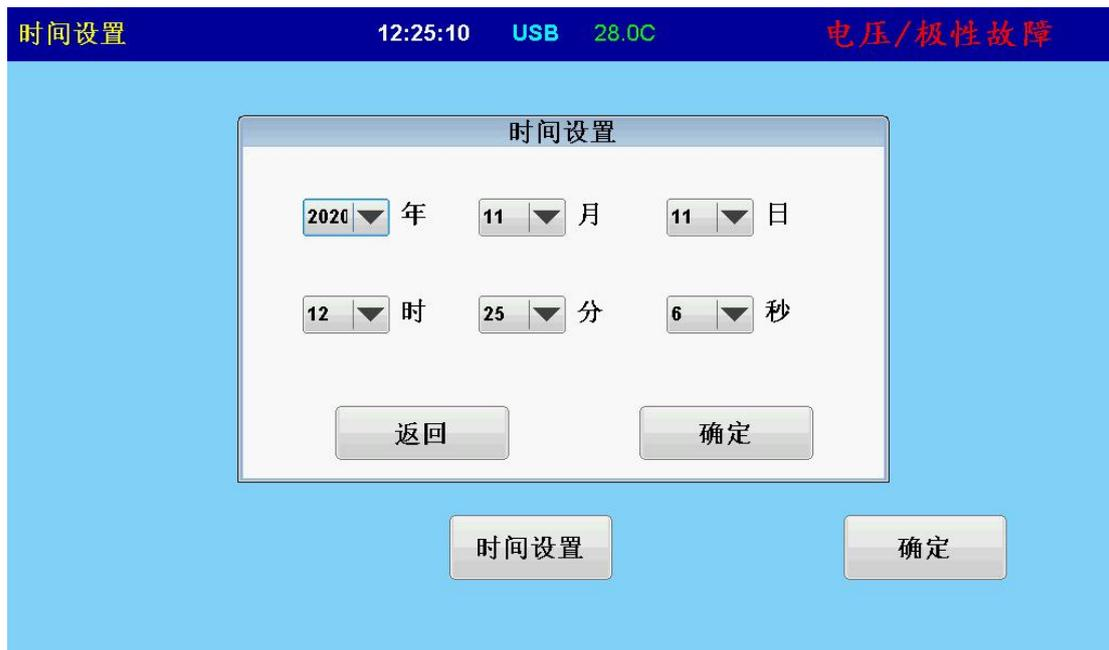
当需要更改本机系统时间时，点击【系统设置】界面中的【时间设置】按钮，即可弹出时间设置对话框，设置好相应的时间下拉列表后，点击【确定】按钮后即刻生效。
